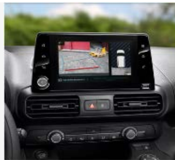
Ar navigācijas sistēmu savienota atpakaļskata kamera
